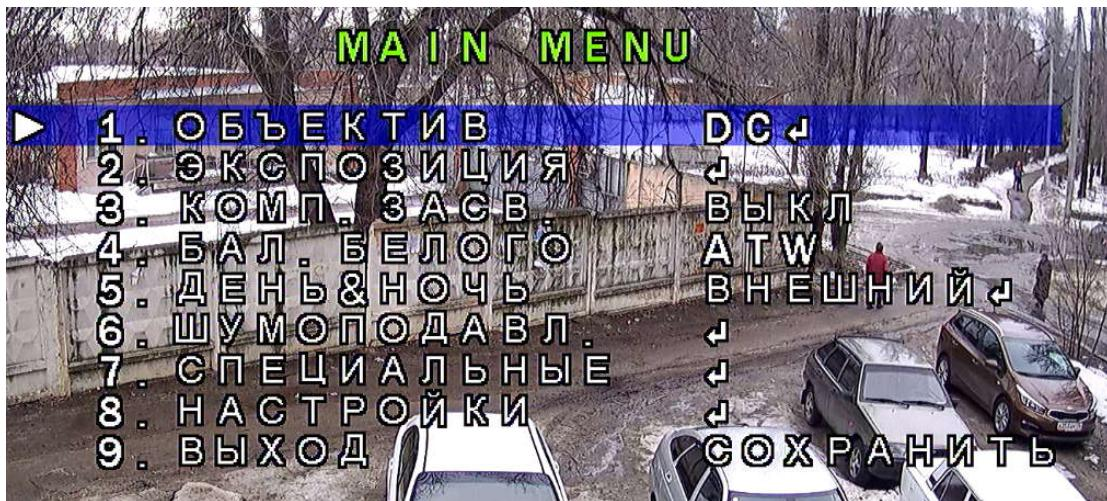
**1. Объектив:** DC или Ручной – данная опция применяется при использовании объектива с АРД (Автоматически Регулируемая Диафрагма), она позволяет выбрать способ управления диафрагмой по значению постоянного тока – DC.
